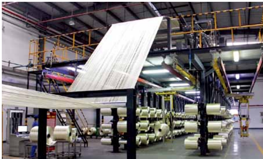
碳纤维原丝生产线
